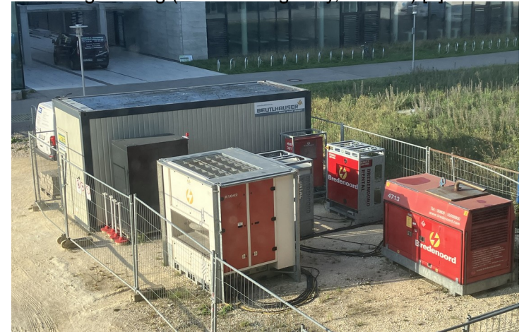
Abbildung 2: Der Inselnetz-Testaufbau am Campus der OTH Regensburg (Foto: Ludwig Brey, FENES) [1]
