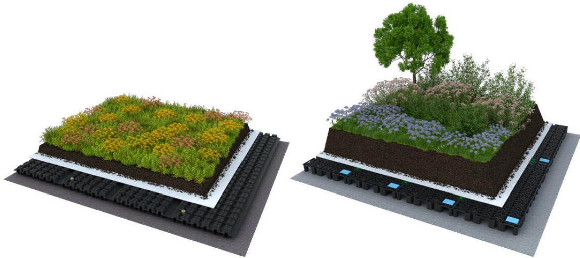
Abbildung 3: Aufbau eines Retentionsgründach (extensiv/intensiv) mit Kunststoffhohlkörper und Kapillarbrücken.
