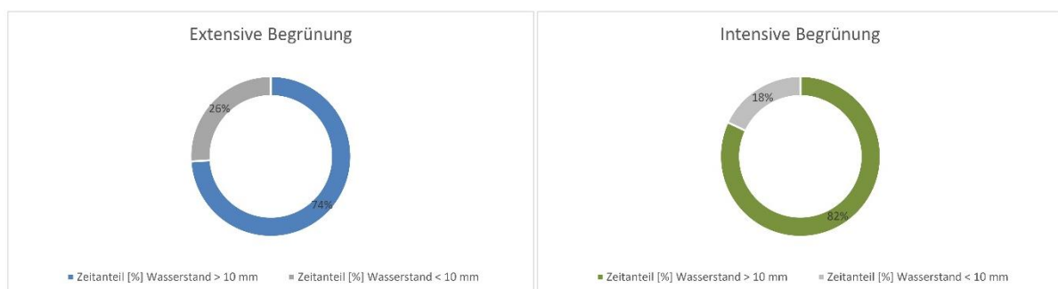
Abbildung 8: Zeitanteil mit einem Wasserstand > 10 mm auf Dächern mit intelligenten Ablaufdrosseln.
