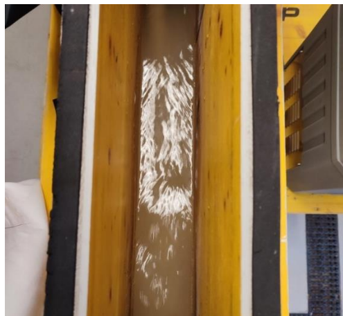
Abbildung 1: Draufsicht auf die Versuchsrinne. Die hyperspektrale Kamera wurde installiert, um die Wasseroberfläche kontinuierlich zu überwachen.
