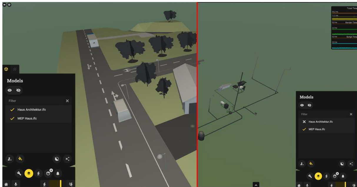
Abbildung 1: In VREX™ dargestelltes Modell einer Trennkanalisation mit häuslichem Anschluss (Virtuelle Realität); Über die Layer-Funktion kann das Model „Haus Architektur“ komplett ausgeblendet werden (rechts).
