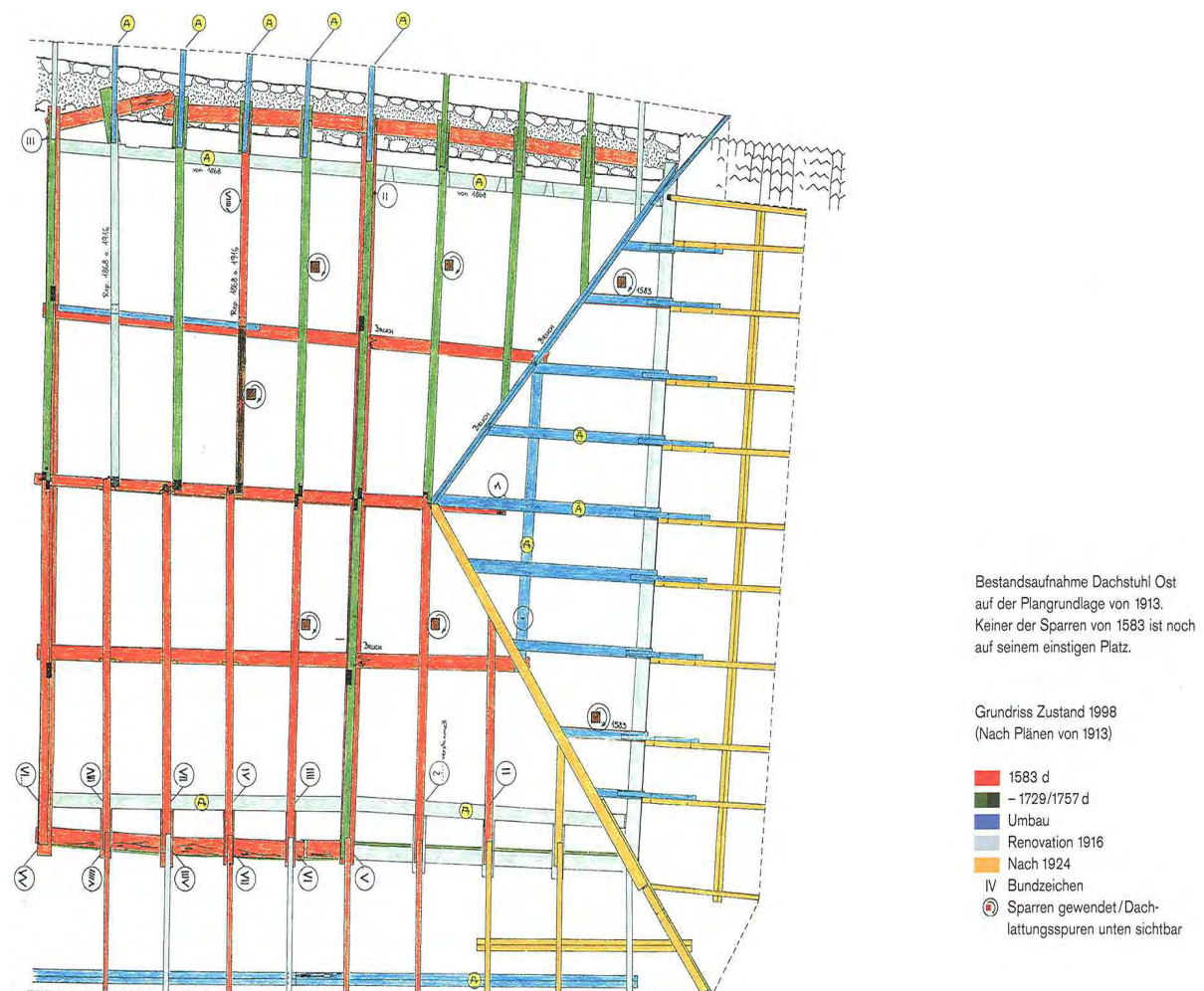
Abb. 2.3: Darstellung der Historie eines Dachstuhles beim Schloss Halwill, Schweiz [5]
