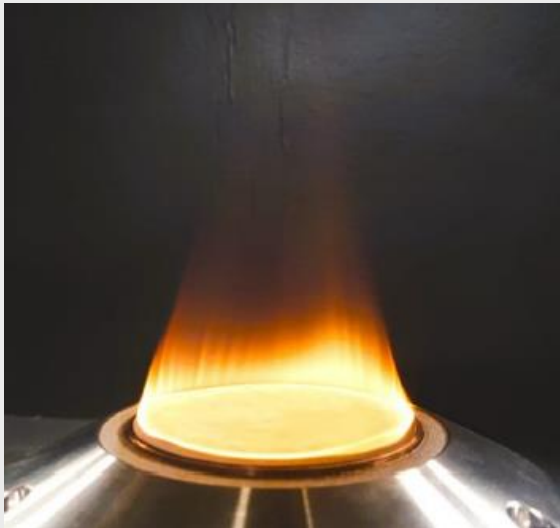
Abbildung 1: 1 kW Ammoniak-Flamme am McKenna-Brenner (Quelle: Masterarbeit Kühebacher)
