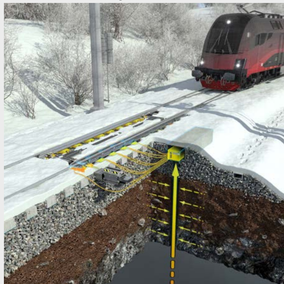
Abb.: „Geothermische Weichenheizung“ zur Eis- & Schneefreihaltung
