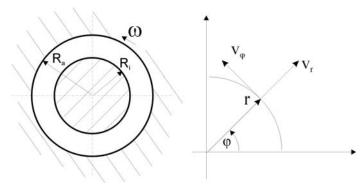
Der innere Zylinder (Radius  $R_i$ ) steht still und der äußere Zylinder (Radius  $R_a$ ) rotiert mit der konstanten Winkelgeschwindigkeit  $\omega$ . Unter der Voraussetzung, dass die Zylinder sehr lang sind, kann die Strömung als zweidimensional  $(r,\phi)$  betrachtet werden, wobei  $v_r$  die Radialgeschwindigkeit und  $v_\phi$  die Umfangsgeschwindigkeit bezeichnen.
