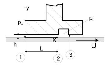
Der linke Teil des Gleitschuhes bildet mit der Stützebene einen Spalt von der Länge L und konstanter Höhe h. An der Stelle "2" mündet der Spalt in eine Kammer, die an der Stelle "3" durch eine Dichtlippe gegen die bewegte Stützebene vollkommen abgedichtet ist. An der Stelle "1" wirkt der Außendruck pa auf den Schmierfilm, und in der Kammer (damit auch an der Stelle "2") herrscht der Innendruck pi, der vorerst noch unbekannt ist.
