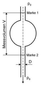
Zu Messzwecken werden die Kapillare und der obere Behälter mit der zu prüfenden Flüssigkeit gefüllt. Nach Beginn des Strömungsvorganges wird die Zeit gestoppt, die vergeht, bis das genau definierte Messvolumen ausgelaufen ist (Durchgang des Meniskus durch zwei Messmarken). Der Durchmesser der Kapillare ist so gering, dass die Strömung sicher laminar ist.
