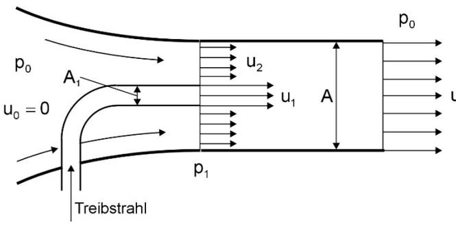
Berechnen Sie die Geschwindigkeit  $u$  am Austritt nach der Vermischung. Dazu seien  $A = 3 \text{ cm}^2, A_1 = 1 \text{ cm}^2, u_1 = 1,8 \text{ m/s}$ .
