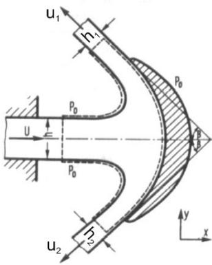
Der auftreffende Strahl wird symmetrisch nach zwei Seiten um den Winkel  $(180^\circ - \beta)$  umgelenkt. Die Geschwindigkeit der Schaufel in  $x$ -Richtung beträgt  $U_0$  (siehe Skizze).
