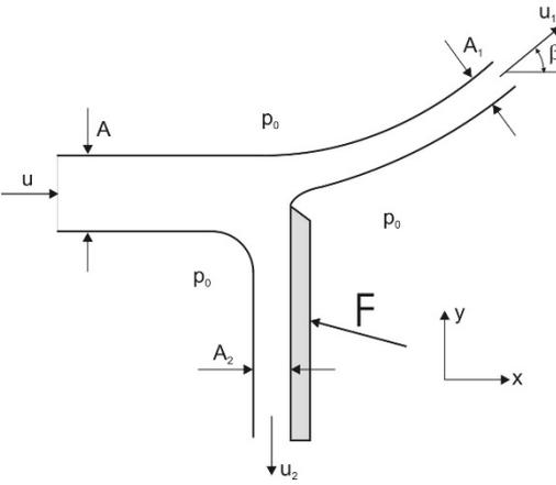
Ein ebener Flüssigkeitsstrahl trifft teilweise so auf eine Schneide, dass ein Teil des Massenstromes längs der Schneide abfließt. Dafür ist bekannt, dass der Reststrahl um einen bestimmten Winkel  $\beta$  aus der ursprünglichen Richtung abgelenkt wird.
