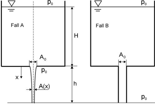
Für Fall A sind die Ausflussgeschwindigkeit aus der Öffnung und die Geschwindigkeit des Flüssigkeitsstrahles nach Durchlaufen einer Höhe  $h$  zu berechnen. Weiterhin soll der Verlauf des Strahlquerschnittes  $A(x)$  unterhalb der Ausflussöffnung bestimmt werden.
