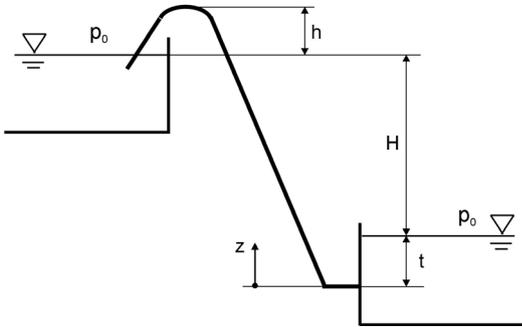
Zwei sehr große Wasserbecken sind durch eine dünne Rohrleitung (Durchmesser  $D$ ) verbunden. Die zeitlich konstanten Spiegelhöhen der Becken liegen auf unterschiedlichem Niveau mit dem Höhenunterschied  $H$ . Die Füllstände bleiben konstant.
