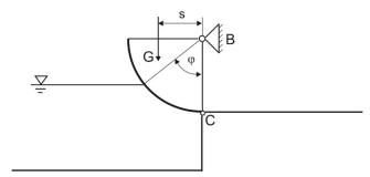
Das Becken ist mit Wasser der Dichte  $\rho$  bis zu einer Höhe gefüllt, die in Form des Winkels  $\phi$  bezüglich des Koordinaten-ursprungs des Zylinders gegeben ist.
