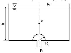
Berechnen Sie die Kraft, die zum Öffnen des Abflusses erforderlich ist.
