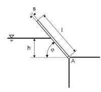
Die Verschlusskraft wird dabei durch das Eigengewicht der Platte (Breite b, Länge l, Dicke s, Dichte des Plattenmaterials  $\rho_P$ ) erreicht.
