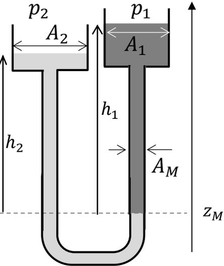
f) Eine Variante dieses Manometers kann durch die Einführung von Flüssigkeitsreservoirs mit unterschiedlichen Querschnitten realisiert werden, siehe Skizze. Hier,  $A_1 = 10A_M$  und  $A_2 = 20A_M$ . Berechnen  $\Delta p$  als Funktion der Meniskusverschiebung  $\Delta h_M$ . Geben Sie eine graphische Interpretation. Vergleichen Sie die Leistungen der beiden Geräte für  $A_M \ll A_1 \approx A_2$ .
