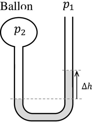
Manometer auf Quecksilberbasis (Hg) werden seit langem verwendet, um den Blutdruck von Patienten zu messen. Der Ballon wird in engem Kontakt mit dem Arm des Patienten befestigt und überträgt den Druck,  $p_{Blut} = p_{Ballon} = p_2$ . Der Umgebungsdruck ist  $p_1$  und die Druckdifferenz kann mithilfe der Quecksilbersäule interpretiert werden. Ein gesunder Patient hat eine Systole (höheren Blutdruckwert) von 120 mmHg und eine Diastole (niedrigeren Blutdruckwert) von 80 mmHg.
