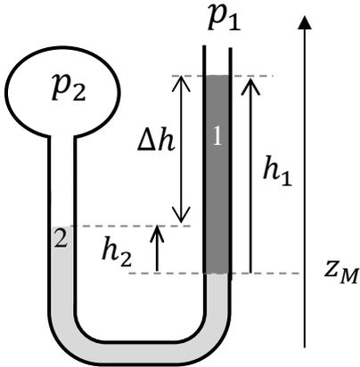
Zur Verbesserung der Spezifikationen des Manometers (maximale Druck und Genauigkeit) wird vorgeschlagen, zwei nicht mischbare Flüssigkeiten zu kombinieren, siehe Skizze. Die Flüssigkeit 1 hat eine feste Säulenlänge  $l_1$  und wir nehmen an, dass sie vollständig auf der rechten Seite des U-förmigen Rohrs verbleibt.
