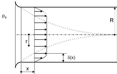
Es soll davon ausgegangen werden, dass die Strömung laminar ist und das Geschwindigkeitsprofil durch folgende Beziehungen (mit  $\delta = \delta(x)$ ) angenähert werden kann:
