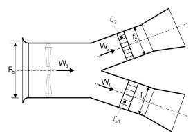
Der Einfachheit halber soll auf die Berücksichtigung der Staubbeladung verzichtet werden. Die Berechnung kann also für reine Luft erfolgen. Die Rohrreibung sowie jene Verluste, die bei der Trennung des Luftstromes auftreten, sollen vernachlässigt werden. Die Gebläsekennlinie (der Zusammenhang zwischen Drucksteigerung  $\Delta p$  und der Geschwindigkeit  $W_0$ ) ist durch folgende Beziehung gegeben:
