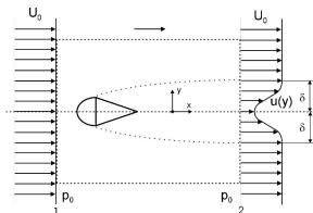
Druck und Geschwindigkeit im Querschnitt "1" sind konstant. Im Querschnitt "2" ist der Druck ebenfalls konstant und gleich wie in "1", und außerhalb des Nachlaufes ist die Geschwindigkeit konstant und gleich U<sub>0</sub>. Die Nachlaufbreite 2δ ist aus Messungen bekannt, die gemessene Geschwindigkeitsverteilung kann durch die folgende Beziehung angenähert werden:
