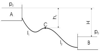
Zwei große Behälter A und B (Höhen-unterschied zwischen den Wasserspiegeln H) sind durch eine Rohrleitung (D, l<sub>1</sub>, l<sub>2</sub>) miteinander verbunden, und bei Bedarf kann Wasser (Dichte ρ, kinematische Zähigkeit ν) von A nach B fließen. Die Rohrleitung muss zwischendurch über ein Hindernis geführt werden, dessen höchster Punkt bei C liegt (Rohrlänge bis C: l<sub>1</sub>).
