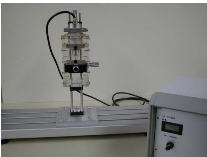
Akustischer Levitator in einem Gehäuse aus Acrylglas. Im Vordergrund der Treiber für den piezoelektrischen Schwinger.
