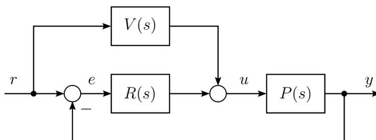
a) Bestimmen Sie die Führungsübertragungsfunktion  $T(s) = \frac{\bar{y}(s)}{\bar{r}(s)}$  allgemein in Abhängigkeit von  $V(s)$ ,  $R(s)$  und  $P(s)$ .
