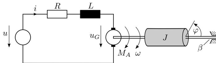
wobei  $J$  dem Trägheitsmoment des Motors entspricht. Weiters wirkt auf den Motor ein drehzahlproportionales Reibmoment  $M_R = \beta\omega$ . Das erzeugte Drehmoment ist proportional zum Strom im elektrischen Netzwerk, d.h.  $M_A = k_T i$ , die vom Motor induzierte Spannung ist proportional zur Drehzahl, d.h.  $u_G = k_m \omega$ . Die Parameter  $\beta$ ,  $k_T$  und  $k_m$  sind positive Konstanten. Die Spannung  $u$  kann variiert werden.
