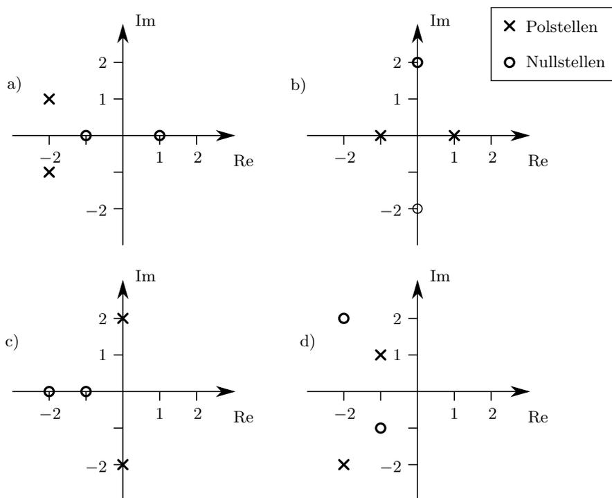
Überprüfen Sie für jeden der vier Fälle, ob es sich um einen PN-Plan einer Übertragungsfunktion eines BIBO-stabilen, zeitkontinuierlichen, linearen zeitinvarianten Übertragungssystems mit reellen Koeffizienten handelt.
