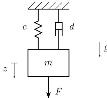
Der Aufbau befindet sich in einem Schwerfeld mit der Gravitationsbeschleunigung  $g$ . Die Federkraft ist proportional zur Auslenkung  $z$  mit dem Proportionalitätsfaktor  $c$ . Die Proportionalitätskonstante der geschwindigkeitsproportionalen Dämpfung sei  $d$ . Auf die Masse  $m$  wirkt außerdem die extern aufgebrauchte Kraft  $F$ .
