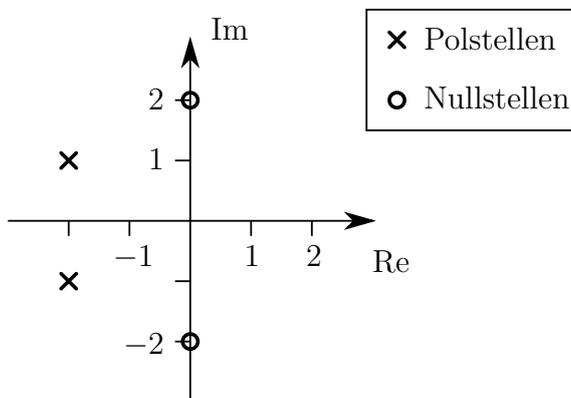
Weiters ist bekannt, dass für das Ausgangssignal  $\lim_{t \rightarrow \infty} y(t) = 16$  gilt, wenn als Eingangssignal  $u(t) = 4\sigma(t)$  gewählt wird.
