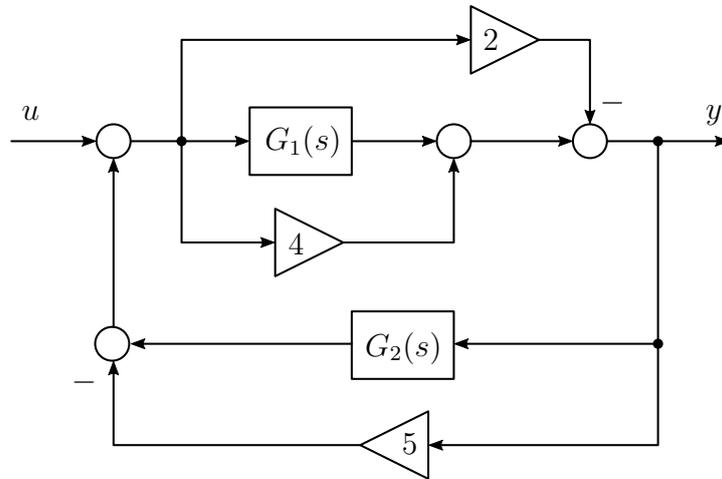
Ermitteln Sie die Übertragungsfunktion  $G(s)$  des Gesamtsystems mit der Eingangsgröße  $u$  und der Ausgangsgröße  $y$ . Geben Sie  $G(s)$  in einer Form ohne Doppel- bzw. Mehrfachbrüche an.
