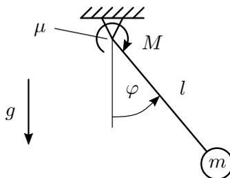
Fassen Sie das Pendel als ein System mit der Eingangsgröße  $u := M$  und der Ausgangsgröße  $y := \ddot{\varphi}$  auf, wobei  $\ddot{\varphi}$  die Winkelbeschleunigung ist.
