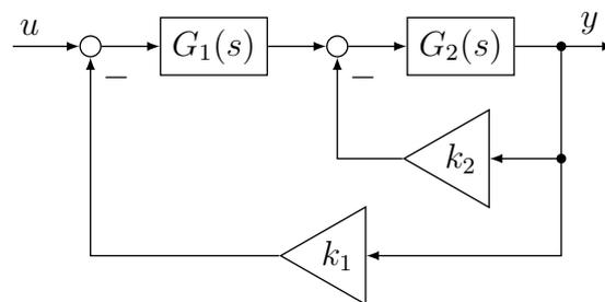
Hierbei sind  $k_1$  und  $k_2$  reelle Parameter. Ermitteln Sie die Übertragungsfunktion  $G(s)$  des Gesamtsystems mit der Eingangsgröße  $u$  und der Ausgangsgröße  $y$ . Geben Sie  $G(s)$  in einer Form ohne Doppel- bzw. Mehrfachbrüche an.
