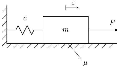
Die Federkraft ist proportional zur Auslenkung  $z$  mit dem Proportionalitätsfaktor  $c$ . Zwischen der Masse  $m$  und dem Boden wird Coulomb'sche Reibung angenommen, das heißt die Reibkraft wird durch  $F_R = mg\mu \text{sign}(\dot{z})$  modelliert.
