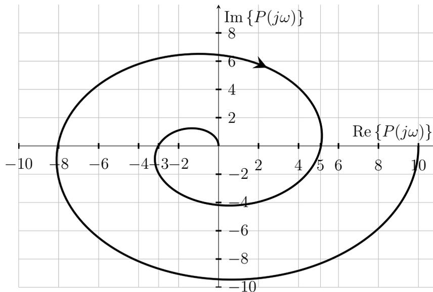
Als Regler kommt ein Proportionalregler  $R(s) = K$  mit dem reellen Parameter  $K$  zum Einsatz. Ermitteln Sie mit Hilfe des Nyquist-Kriteriums nachvollziehbar, d.h. mit Fallunterscheidung und Ermittlung der stetigen Winkeländerung für jeden Fall, den größtmöglichen Wertebereich des Reglerparameters  $K$ , für den der Regelkreis die BIBO-Eigenschaft besitzt.
