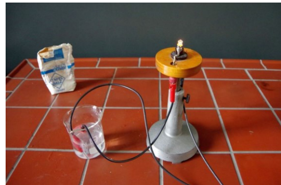
Abbildung 94: Glühlampe leuchtet mit Salz im Wasser (Bild: W. Winkler)
