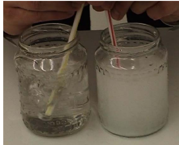
Abbildung 42: Luftblasen bei gleicher Füllhöhe aber unterschiedlicher Dichte
