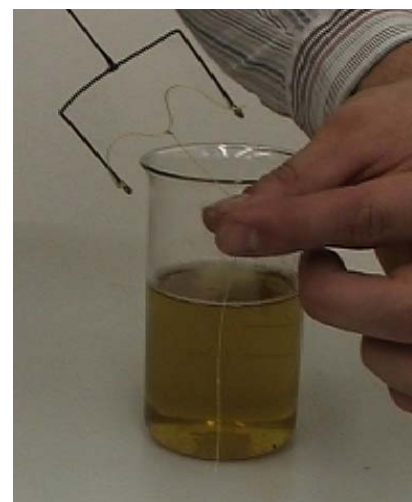
Abbildung 44: Seifenhaut zwischen Metallbügel und Faden
