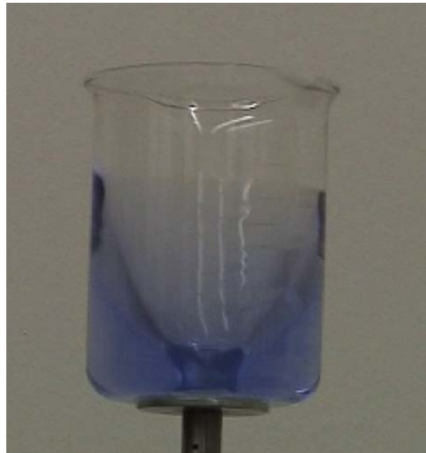
Abbildung 12: Rotationsparaboloid bei erhöhter Drehzahl
