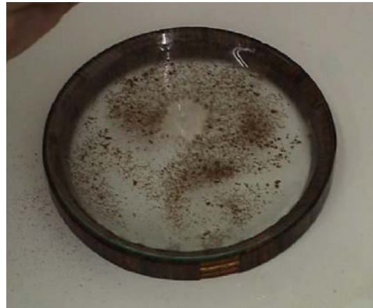
Abbildung 49: Ein Seifentropfen verringert die Oberflächenspannung von Wasser
