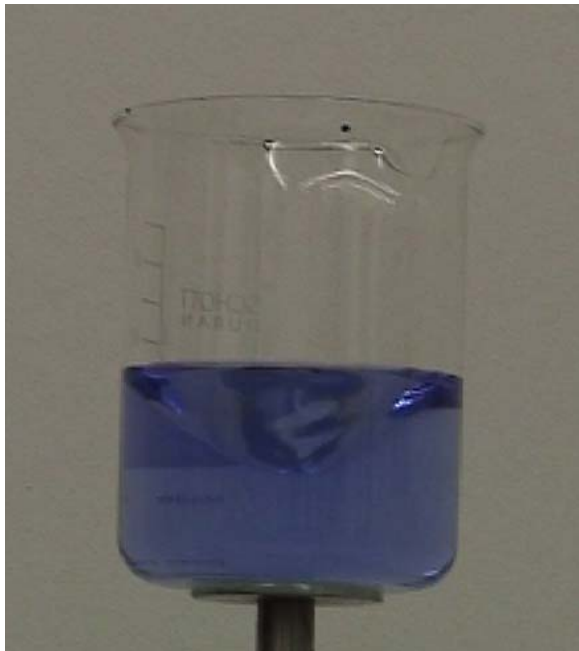
Abbildung 11: Rotationsparaboloid einer Flüssigkeitsoberfläche
