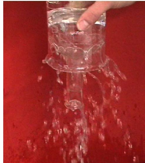
Abbildung 18: Demonstration des Luftdrucks mit ineinander passenden Gefäßen
