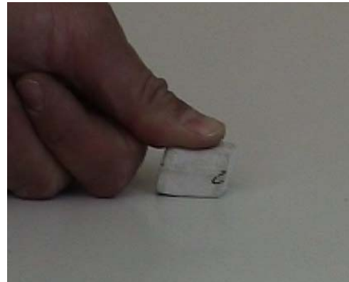
Abbildung 3: Schubmodul anhand eines Radiergummis
