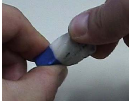
Abbildung 4: Torsionsmodul anhand eines Radiergummis
