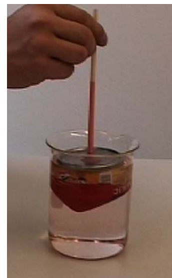
Abbildung 22: Ein Messgerät für den hydrostatischen Druck
