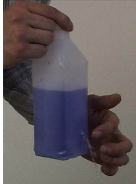
Abbildung 53: Drei Wasserstrahlen werden zu einem verbunden
