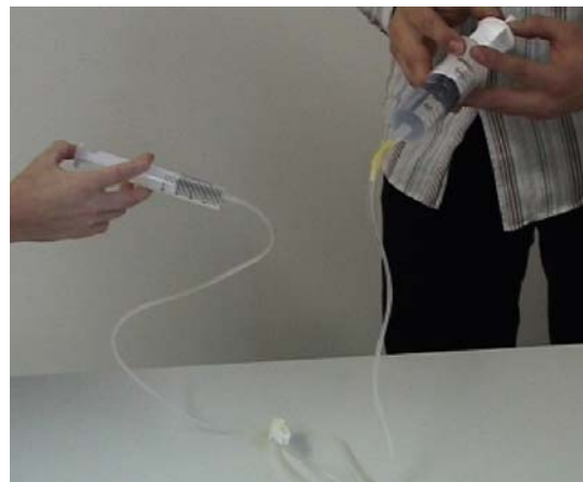
Abbildung 10: Hydraulische Presse mit zwei unterschiedlichen Spritzen
