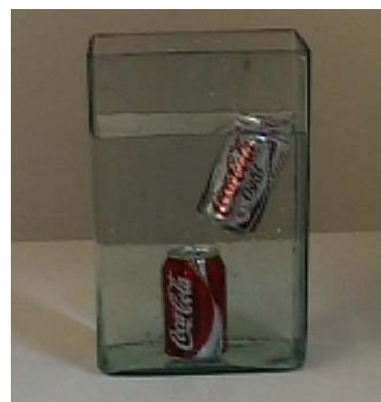
Abbildung 43: Auftrieb von Cola bzw. Cola-Light
