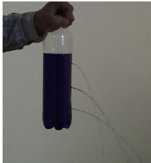
Abbildung 21: Der hydrostatische Druck in einer gefüllten Flasche
