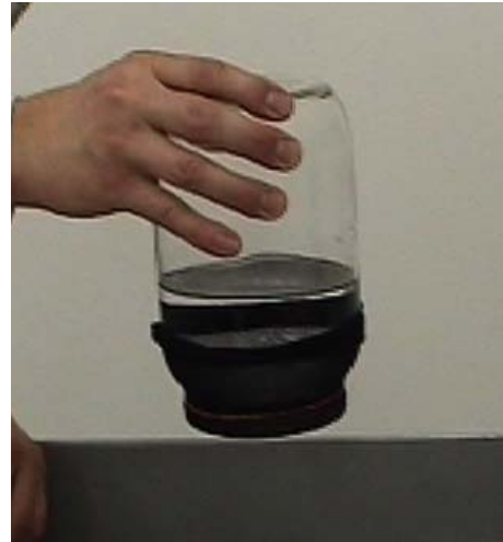
Abbildung 58: Demonstration der Wasserundurchlässigkeit einer Strumpfhose
