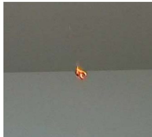
Abbildung 25: Das Aschegerüst des Teebeutels beim Abheben
