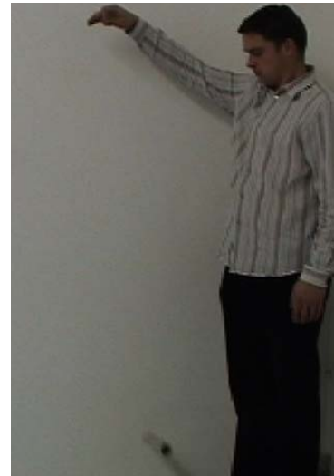
Abbildung 72: Demonstration des Magnus-Effekts mit Hilfe eines fallenden Zylinders
