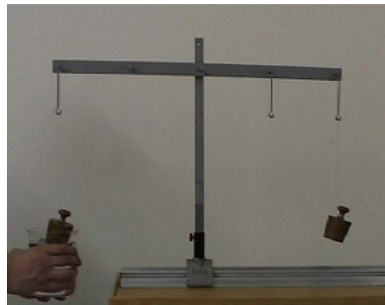
Abbildung 34: Auftrieb eines Gewichts bei einer Balkenwaage
