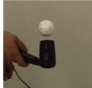
Abbildung 68: Ein Porocellball im Luftstrom eines Föhns
