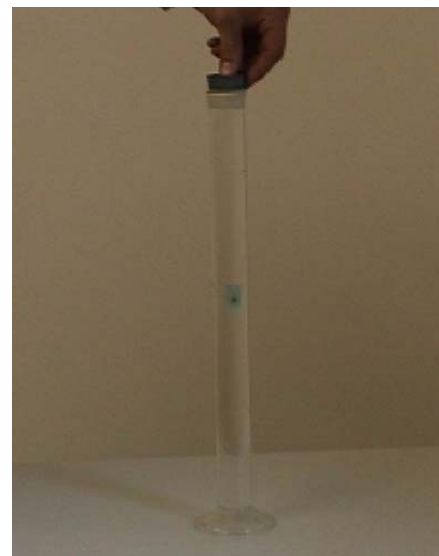
Abbildung 37: Das Original des Cartesianischen Tauchers
