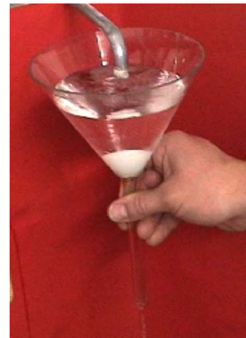
Abbildung 32: Tischtennisball im Sog eines Trichters
