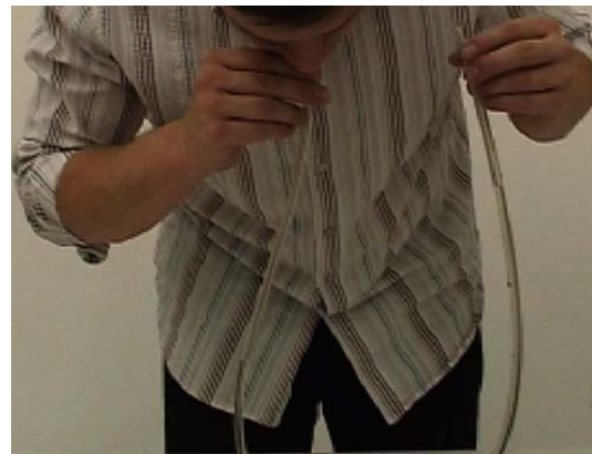
Abbildung 15: Ein offenes Manometer in Form eines Schlauches
