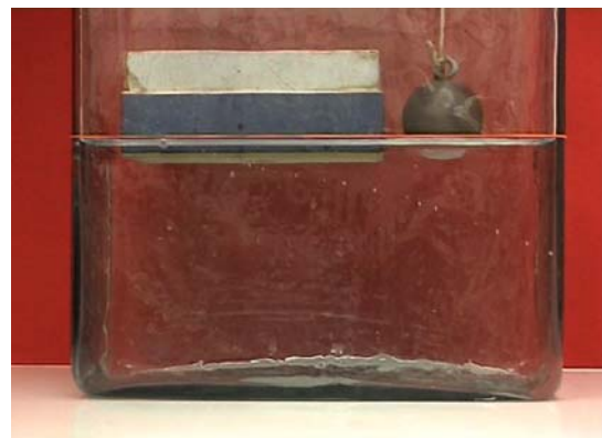
Abbildung 35: Volumenverdrängung unterschiedlich geformter Gegenstände
