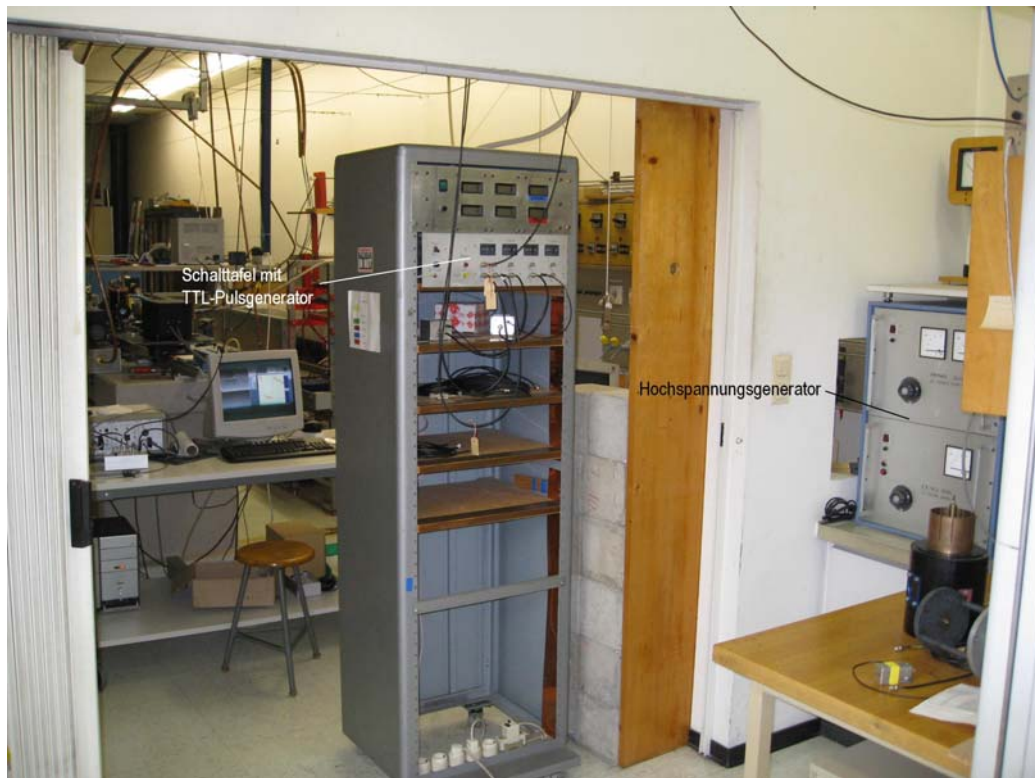
Abbildung 3.4: Stromlade- und Steuereinheit des Pulsheizexperiments
