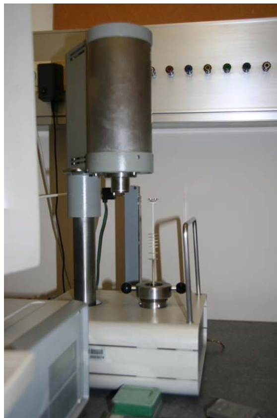
Abbildung 3.9: Hochtemperatur DSC am Institut für Experimentalphysik der TU Graz
