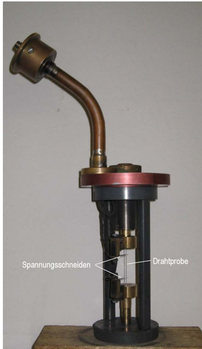
Abbildung 3.5: Probenhalter mit bereits eingespanntem Stahldraht
