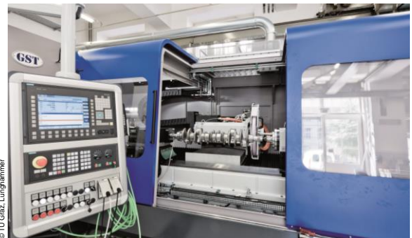
CNC-Forschungsschleifmaschine – weltweit einzigartige Spitzentechnologie für 3D-Unrund-Geometrien (ProLab)
